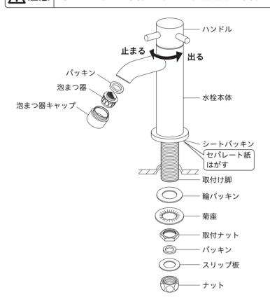
※蛇口を取付ける際、水流が排水口 カバーに落ちるように角度を調節 してください。
