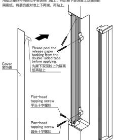
◎How to remove the cover 装饰盖的拆卸方法
