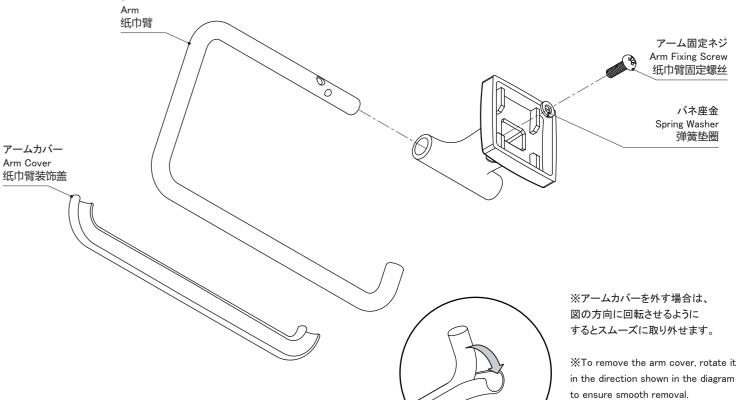
◎ ペーパー左差し仕様変更手順 / Procedure for arm direction change / 厕纸架变更为左向型的安装方法
