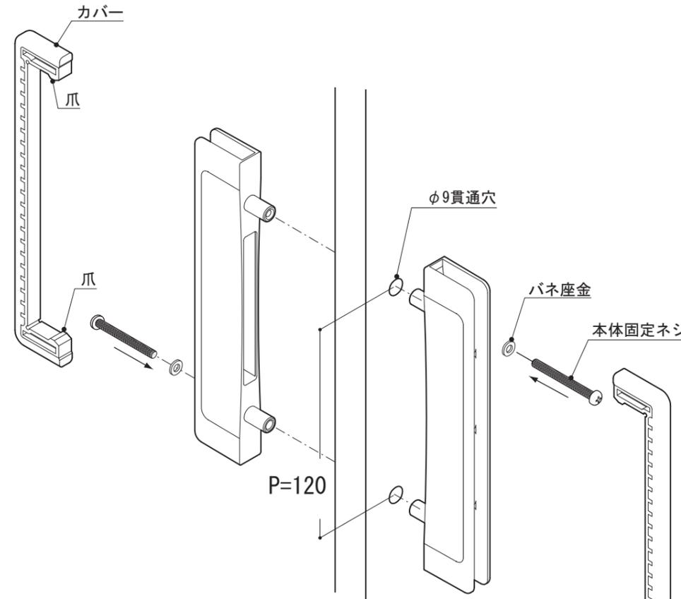
取り外しは、本体とカバーとの隙間にマイナスドライバーを挿込んだ後、ドライバーを回転させると爪が外れ、カバーを取り出せます。
