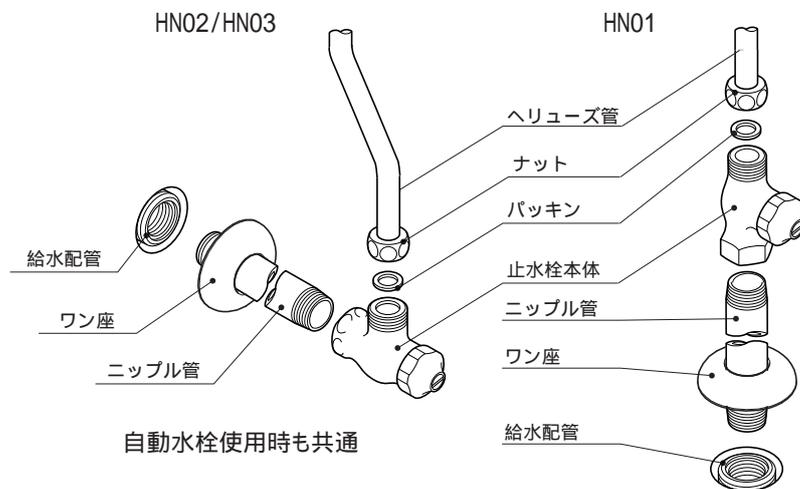
給水配管にニップル管、止水栓本体を取付けてください。ネジ部にシールトープ等のシール剤を巻きつけてしっかりネジ込んで固定してください。
